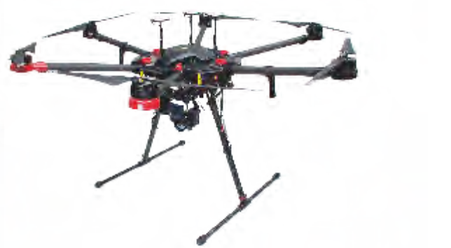
基于大疆M600、M200、S1000、S900系列无人机之红外热成像任务系统
