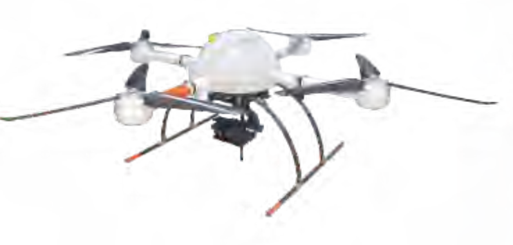
基于工业级MD4-1000无人机之红外热成像任务系统
